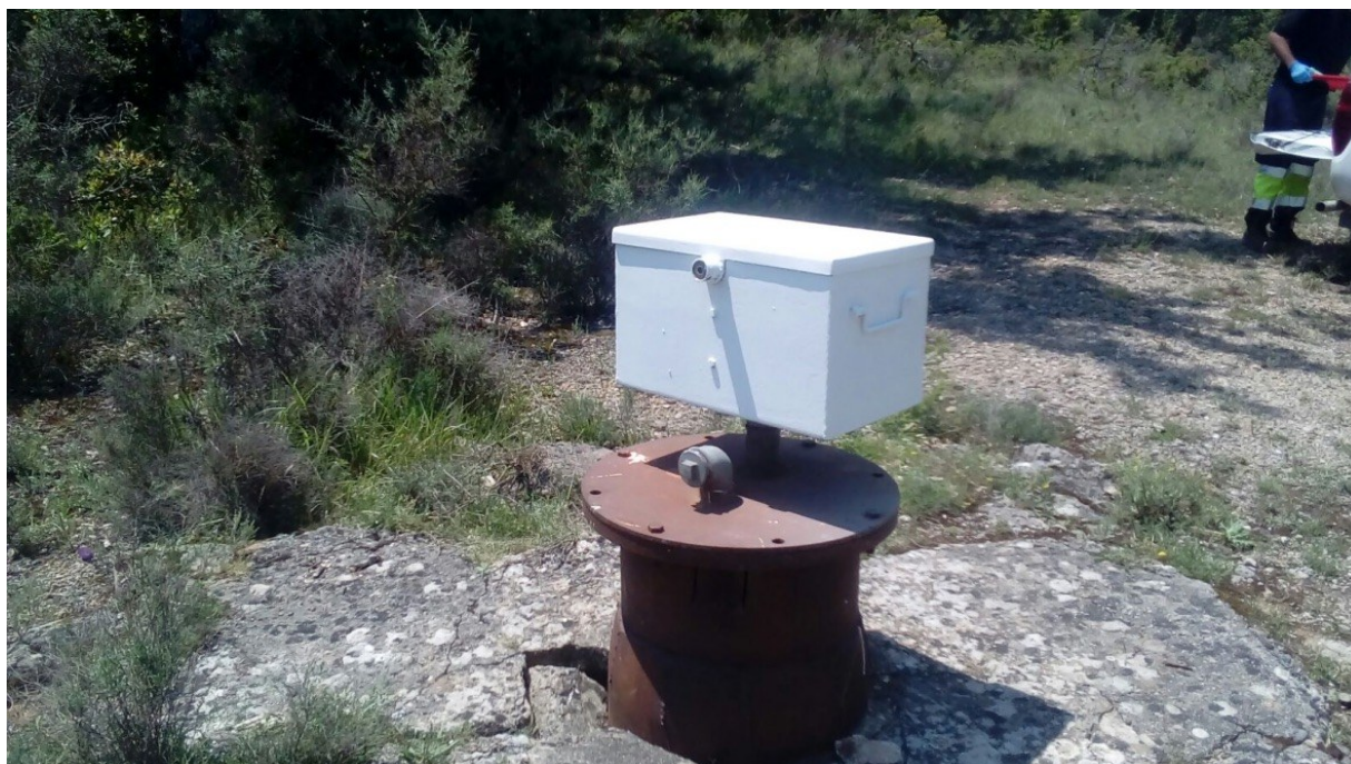
Foto 15 Estación de control piezométrico SP02-Sondeo ORBISO-2. (Foto TELUR).
